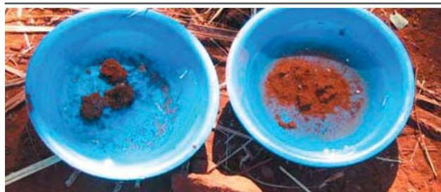
**Figure 3 : Un essai sur le terrain de la stabilité de l'agrégat. Les petites mottes d'un champ labouré (à droite) et de terre vierge (à gauche) ont été soigneusement déposées dans l'eau. Les mottes de couleur plus claire du champ labouré se désintègrent tandis que les mottes du sol vierge restent intactes.**
